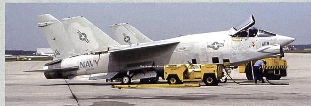
Les lignes caractéristiques du *Crusader* se retrouvent sur le RF-8 de reconnaissance. Les canons et les pylônes ont été démontés et une batterie de caméras a été installée sous la prise d'air du réacteur.
