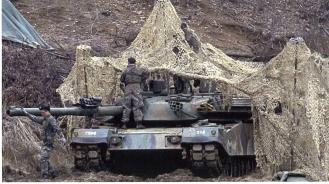
Ci-dessus: Le K1 ou ROKIT rappelle certaines lignes du M-1 *Abrams* américain. Il est doté du même canon de 120 mm L44 et dispose d'une suspension hydropneumatique.
