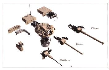
Le concept de tourelle modulable permet à une force de s'adapter à l'évolution de la menace. Les modifications peuvent être effectuées, si nécessaire, dans le théâtre d'opérations.
