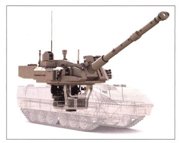
Le canon de 105 mm peut être élevé jusqu'à 42 degrés, permettant de délivrer un feu indirect jusqu'à une distance de 8 km.
