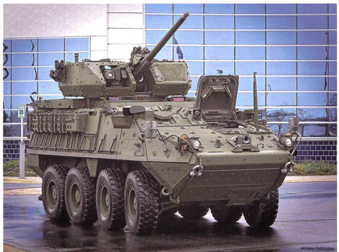
Vue de détail du Dragoon . La tourelle téléopérée de 30 mm confère une puissance de feu supérieure à l'armement du LAV-25 de l'USMC ou du M2/M3 des formations blindées. Mais cette tourelle ne permet pas une observation aussi bonne et une capacité « hunter-killer » comme c'est le cas du M2/M3 dotés d'un périscope ODS pour le commandant de véhicule.
