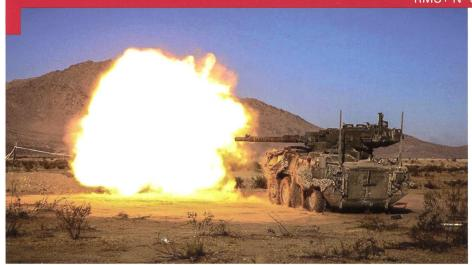
Le M1128 Mobile Gun System n'a pas été conçu comme un char mais comme un engin d'appui aux formations d'infanterie mécanisée montées sur Stryker. A l'origine, un véhicule armé d'un canon de 105 mm devait fournir une couverture et un appui à chaque section montée sur quatre véhicules transport de troupes M1126.
