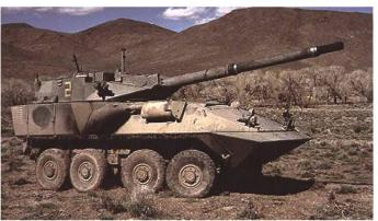
Un critère fondamental pour le choix des engins – qu'il s'agisse de l'*Infantry Carrier Vehicle* (ICV) ou des engins d'appui- est l'aérotransportabilité par un avion de type C-130, ce qui limite le volume ainsi que le poids à 19 tonnes. <sup>4</sup> Comme nous allons le voir, ces critères très limitants sont peut-être la source des problèmes et de la succession d'échecs dans ce domaine.
