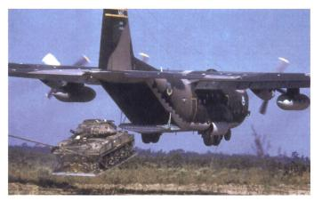
Un char M551 Sheridan « parachuté » par un C-130. En réalité l'appareil est largué à très basse altitude et la plateforme métallique est sensée absorber une partie du choc. Le parachute ne sert qu'à freiner et à stabiliser l'ensemble. Evidemment la photo et l'effet psychologique sont impressionnants, mais des évaluations ont déterminé que 50% des engins ainsi largués connaissent de graves pannes au niveau de leurs organes de visée ou de tir.
