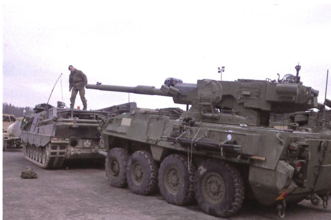
Fin d'exercice peu glorieux pour ce M1128 du 2 nd CR remorqué par un Büffel de la Bundeswehr. La suspension arrière a lâché et les crochets d'attelage touchent le sol.
