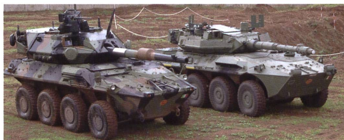
Le Centauro B1 (à droite) est un succès technologique et esthétique. Mais son niveau de protection est excessivement faible et il ne peut être employé dans un environnement véritablement contesté. Le B2 (à gauche) intègre une nouvelle tourelle, afin d'emporter un canon de 120 mm.
