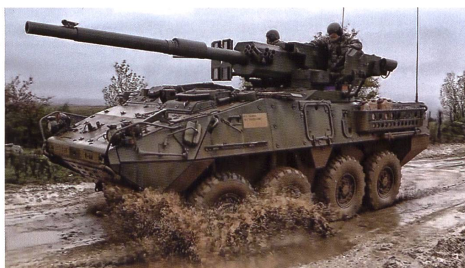
Le M1128 Stryker est une tentative américaine d'employer toutes les technologies disponibles pour réaliser un engin à roues armé d'un canon de 105 mm en-dessous de 19 tonnes.
