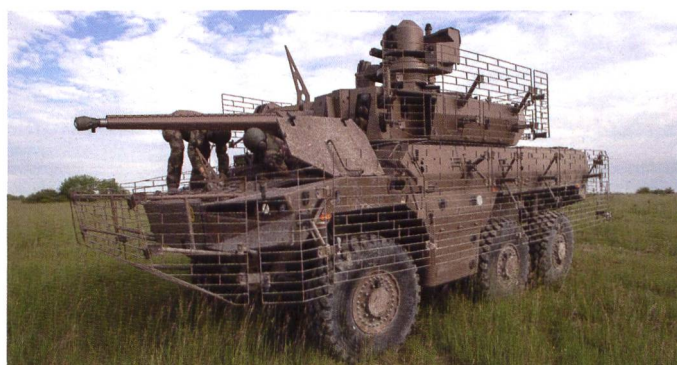
Le Jaguar français est le successeur de plusieurs systèmes à roues. Son armement n'est que de 40 mm afin de combattre la majorité des buts sur le champ de bataille moderne. La capacité antichar prend la forme d'engins guidés pouvant être tirés depuis le côté de la tourelle.
