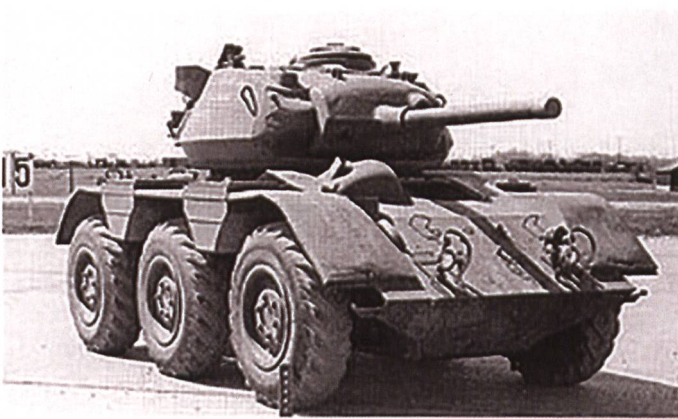
Le succès des M8/M20 a donné lieu au développement par Chevrolet, aux USA, du M38 Wolfhound doté d'une tourelle de char léger M24 Chaffee. Mais la fin de la Guerre a stoppé son développement après la réalisation de quelques prototypes.
