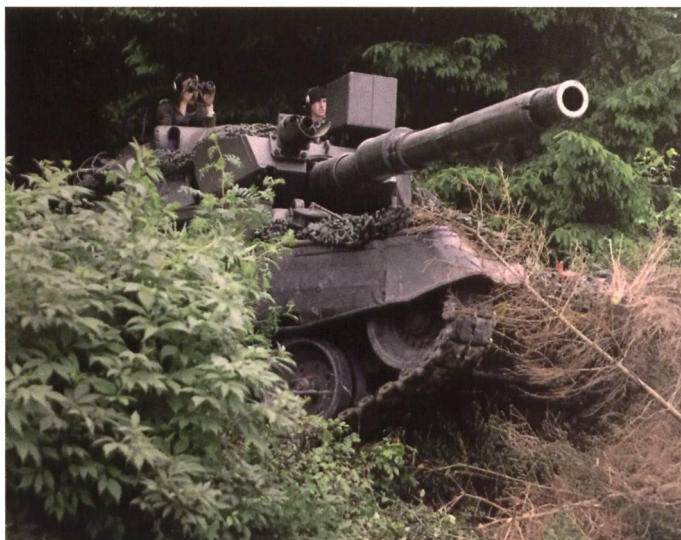
Ce Léopard 1A2 ouest-allemand attend sa proie dans une position camouflée. On voit à gauche du projecteur un système de marquage -surnommé « Hoffman device »- destiné à simuler le départ du coup lors d'exercices dans le terrain.
