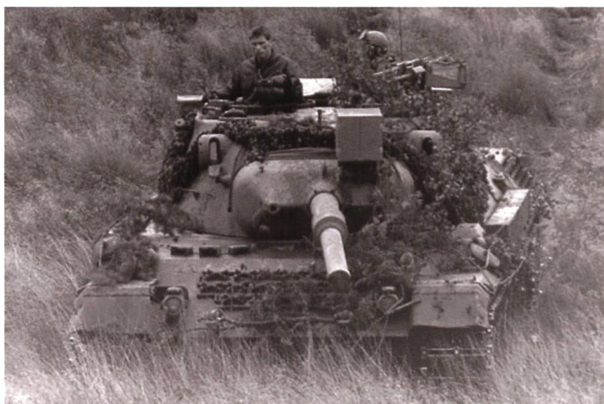
Un Léopard 1BE, qui correspond au standard A2 allemand, prend une position de feu. Les optiques du télémètre optique sont ouvertes et bien visibles. Le boîtier fixé sur le bouclier du canon contient un projecteur de lumière rouge/infrarouge pour le combat de nuit.
