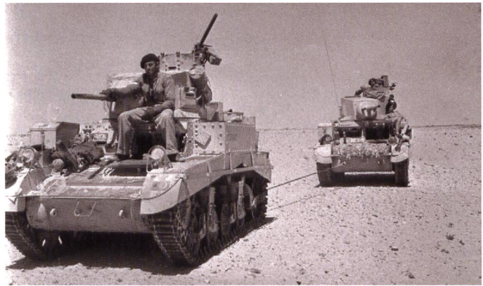
Le char léger M3 Stuart dépasse en performance les cruiser tanks britanniques. Il pèse 15 tonnes, est armé d'un canon de 37 mm et peut rouler jusqu'à 58 km/h. Il est surtout plus fiable et plus endurant que les engins britanniques.
