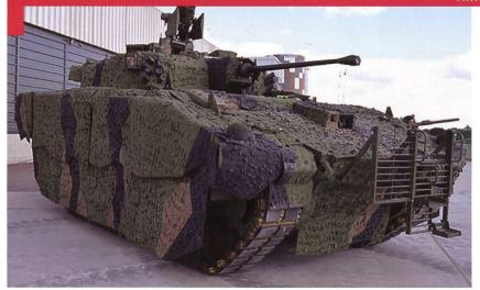
L'Ajax pèse 38 tonnes et peut être porté à 42 avec des protections supplémentaires. Il est armé d'un canon CNIM de 40 mm à munitions télescopées, qui doit également être monté sur le *Warrior* revalorisé. Au moment où ce numéro part sous presse, il est question que le MoD annonce l'abandon de ce programme, après plusieurs années d'incertitudes. Toutes les photos © Crowne Copyright.
