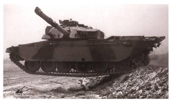
Le « Phase 2 » ou « *Shir* » – lion en persan – est développé en 1974. Il reçoit un nouveau type de blindage composite sur la tourelle. L'arrière de la carcasse est sensiblement modifié pour recevoir un nouveau moteur Rolls-Royce CV12 de 1'200 PS. L'engin dispose de nouveaux barbotins et de nouvelles chenilles. Le prototype est prêt en avril 1977 et destiné à l'Iran. Ce programme est stoppé en février 1979.
