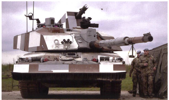
Deux illustrations du haut: Fruit des expériences de l'Irak en 2003, le démonstrateur baptisé « Streetfighter II » effectue une série d'essais à la troupe. Celui-ci permet d'engager et de conduire plusieurs drones terrestres ou aériens simultanément. Il porte l'ancien camouflage des unités de la brigade de Berlin.
