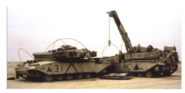
Maintenance en campagne, en Arabie saoudite. L'engin de dépannage a soulevé les plaques du capot-moteur et s'apprête à sortir le powerpack Rolls Royce. Les arceaux que l'on voit à l'avant servent à déployer des filets de camouflage.
