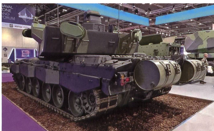
On voit à l'arrière les capteurs du système antimissiles actif Trophy . Ce système est en cours d'installation sur les M1 américains et les Léopard 2A7 allemands.
