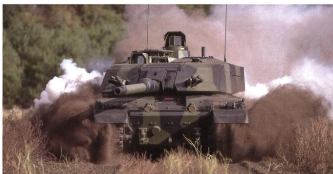
Le démonstrateur du Challenger 3 présenté à la presse spécialisée. Si les lignes sont généralement similaires, la silhouette du char est désormais caractérisée par les deux systèmes optroniques jour/nuit pour le pointeur et le commandant.
