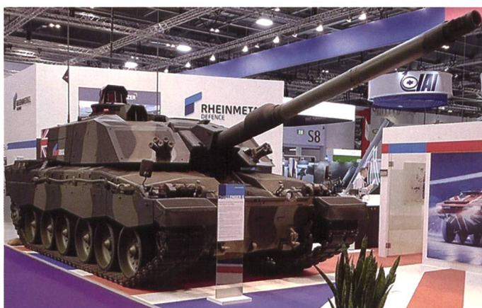
Présentation du char dont on distingue nettement les contours. La version de démonstration ne dispose pas des kits de surblindages montés en opérations et ne pèse « que » 66 tonnes.
