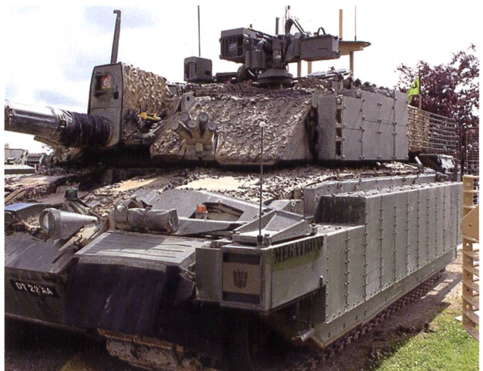
Démonstrateur technologique, le char « Megatron » a servi de base au Challenger 3 . Le « Megatron » dispose, en plus d'un blindage renforcé, d'une tourelle téléopérée pour la défense rapprochée. Les boîtes fixées aux côtés sont des blocs de blindage réactif.
