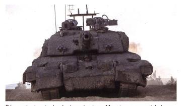
Démonstrateur technologique, le char « Megatron » a servi de base au *Challenger* 3. Le « Megatron » dispose, en plus d'un blindage renforcé, d'une tourelle téléopérée pour la défense rapprochée. Les boîtes fixées aux côtés sont des blocs de blindage réactif.
