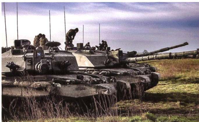
Une section de CR2 sur la plaine de Salisbury. Le CR2 se distingue du modèle précédent par les optiques du pointeur, montées sur le canon (au lieu du côté de la tourelle).
