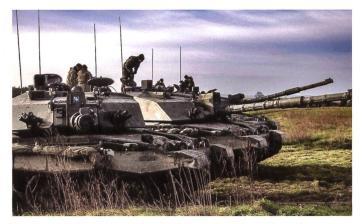
Une section de CR2 sur la plaine de Salisbury. Le CR2 se distingue du modèle précédent par les optiques du pointeur, montées sur le canon (au lieu du côté de la tourelle).
