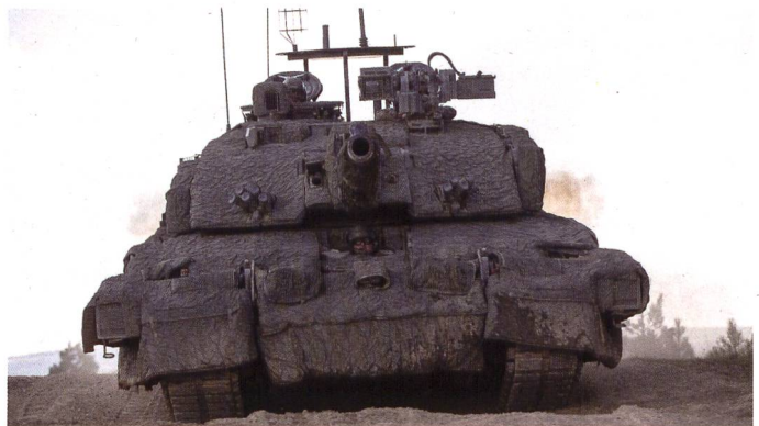
Démonstrateur technologique, le char « Megatron » a servi de base au Challenger 3 . Le « Megatron » dispose, en plus d'un blindage renforcé, d'une tourelle téléopérée pour la défense rapprochée. Les boîtes fixées aux côtés sont des blocs de blindage réactif.
