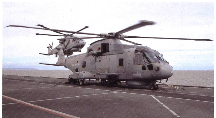
L'hélicoptère Merlin (EH 101) est la bête de somme de la Royal Navy, qui a succédé au Sea King (SH 3). Cet appareil sert au transport, au sauvetage, à la veille aérienne, à la lutte anti-sous-marine ainsi qu'à des missions d'attaques, armés de missiles.
