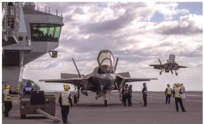
Les appareils appontent. Le kiosque arrière du navire est principalement dédié aux opérations de vol, alors que l'avant sert prioritairement à la navigation.
