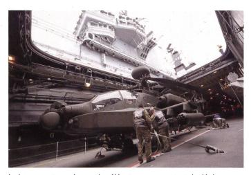
Le hangar est spacieux et les élévateurs permettent de déplacer un AH-64 *Apache* (ci-dessus) ou un EH 101 *Merlin* (ci-dessous), ainsi qu'un CH-47 *Chinook* ou même l'OV-22 *Osprey*. Ce dernier n'est pas en service actuellement dans la Royal Navy.
