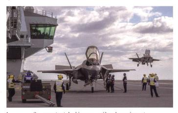
Les appareils appontent. Le kiosque arrière du navire est principalement dédié aux opérations de vol, alors que l'avant sert prioritairement à la navigation.
