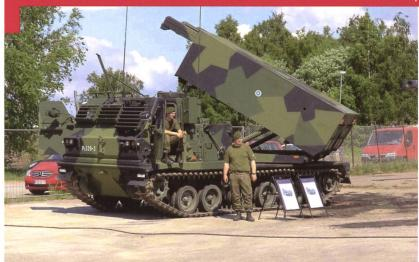
La Finlande met en oveuvre 22 MLRS en tant qu'artillerie opérative, capable d'engager des buts ponctuels jusqu'à 70 km et désormais jusqu'à une portée maximale de 150 km.
