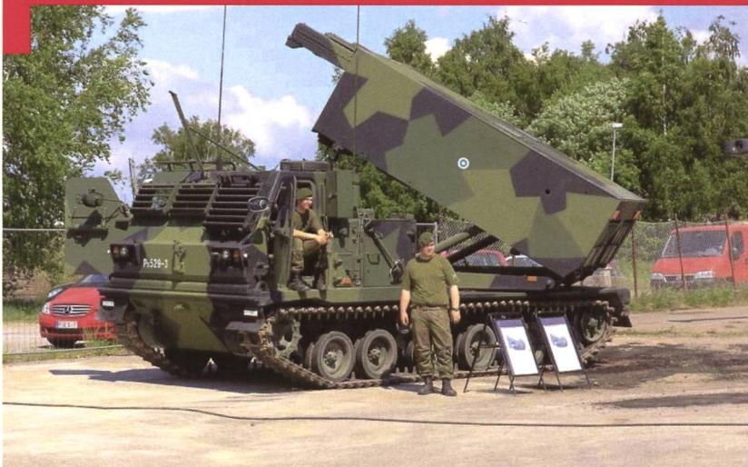
La Finlande met en œuvre 22 MLRS en tant qu'artillerie opérative, capable d'engager des buts ponctuels jusqu'à 70 km et désormais jusqu'à une portée maximale de 150 km.
