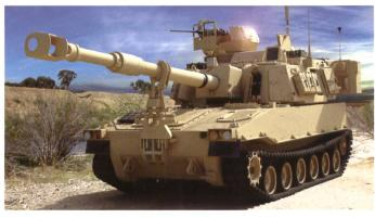
Protoype du M-109A7 disposant de protections supplémentaires, d'un nouveau châssis – identique au M2/M3 – et d'une électronique améliorées.
