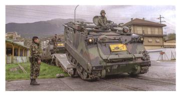
Déchargement d'un char de commandement M-113, reconnaissable à ses nombreux accessoires, radios supplémentaires et une armature à l'arrière permettant d'ériger très rapidement une tente.
