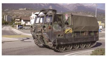
Ci-dessus: Deux vues de la chenillette de transport M-549. Cet engin est construit sur les bases du M-113 vu précédemment. Il partage également de nombreuses pièces de rechange avec le M-109. Cet engin sert au transport de munitions et dispose à cet effet d'outils de levage et de manutention. Les obus d'artillerie sont transportés dans des alvéoles dédiées.
