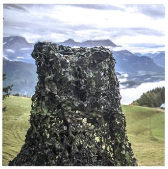
C'est au moyen d'antennes à ondes dirigées R-905 que le bat ondi 16 connecte les différents emplacements à son réseau.
