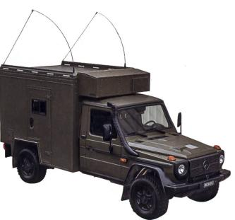
La voiture Radio Access Point (voit RAP) permet d'intégrer dans le RITM des utilisateurs mobiles avec un appareil radio SE-235 et constitue l'interface proprement dite entre le RITM et le réseau radio SE-235. Un RAP permet d'exploiter simultanément cinq liaisons au maximum. L'ensemble du système se compose de la fonctionnalité RAP, des fonctions RITM et du SE-235/435. On parle alors de Combat Network Radio Interface.
