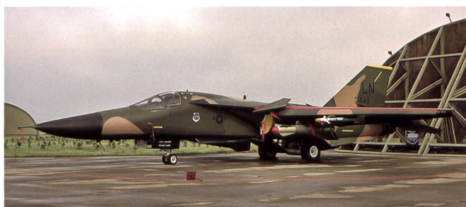
Le F-111F modernisé est en mesure d'emporter et de guider des armes grâce à une nacelle ventrale, escamotable. Cet appareil du 493 TFS porte deux bombes GBU-15 de 1'000 kg et des missiles air-air AIM-9 d'autoprotection.
