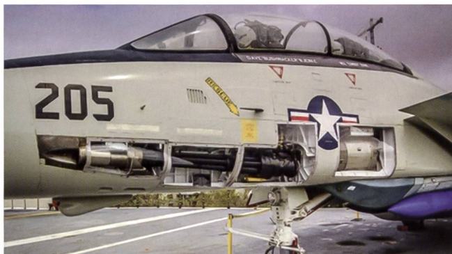
Expérience de la guerre du Vietnam : le F-14 est doté d'armes à courte, moyenne et longue portée. Sans oublier le canon M-61 de 20 mm alimenté de 675 obus.
