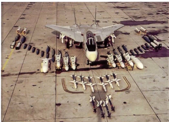
Grumman présente son F-14A entouré des armes et munitions qu'il peut emporter. Bien sûr, toutes ne peuvent être emportées simultanément. On reconnaît au premier plan quatre AIM-9, six AIM-7 et six AIM-54 de part et d'autre du nez de l'appareil.
