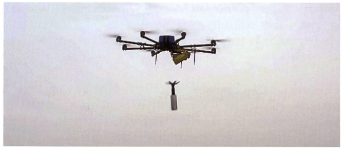
Un R18 Octocopter de la société ukrainienne Aerozvidka. Le système permet de viser et de lâcher une bombe non guidée armée d'une charge creuse.
