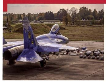
Un Su-27 présente lors d'une journée de démonstration, les armes air-air et air-sol qu'il peut emporter. L'appareil pèse 16'380 kg à vide et peut emporter 9,400 kg de fuel et 4'430 kg de bombes, de roquettes ou de missiles sur une dizaine de pylônes.
