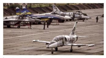
Les avions d'entraînement ne sont pas des bêtes de guerre. On voit bien ici la différence de taille entre le L-39 (3'455 kg à vide) et le MiG-29 (11'000 kg).
