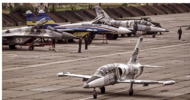
Les avions d'entraînement ne sont pas des bêtes de guerre. On voit bien ici la différence de taille entre le L-39 (3'455 kg à vide) et le MiG-29 (11'000 kg).
