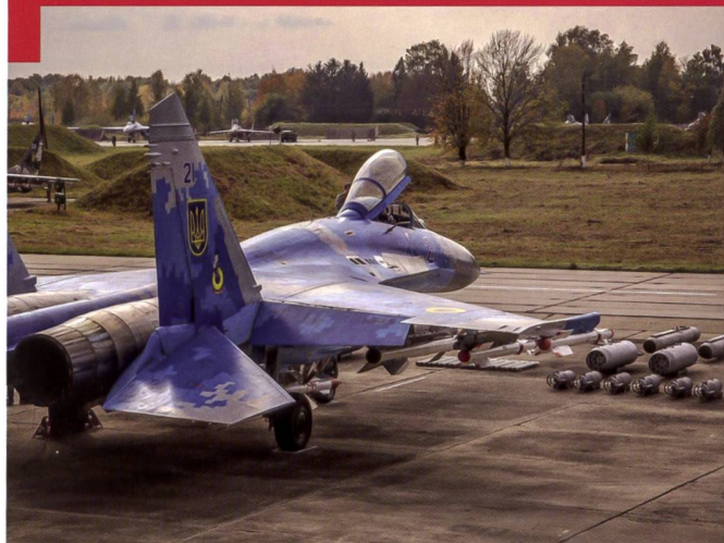
Un Su-27 présente lors d'une journée de démonstration, les armes air-air et air-sol qu'il peut emporter. L'appareil pèse 16'380 kg à vide et peut emporter 9,400 kg de fuel et 4'430 kg de bombes, de roquettes ou de missiles sur une dizaine de pylônes. Toutes les illustrations de l'article sont de l'auteur. © Erik Bruijns.
