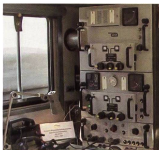
Figure 7 : Station radio SE-415 montée sur camion Steyr.
