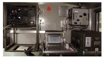
Figure 8: Station radio SE-430 avec ensemble télématique 430 (TmS-430).
