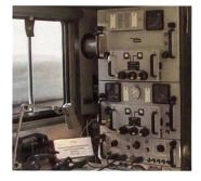
Figure 7: Station radio SE-415 montée sur camion Stevr.
