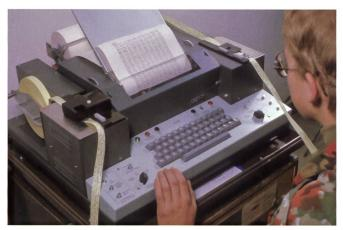
Figure 14: Appareil de chiffrage TC-850 développé dès 1973.
