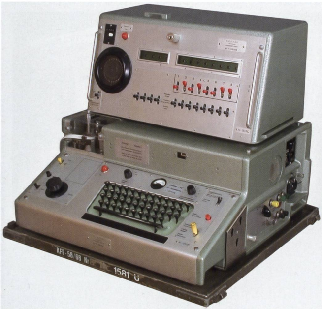
Figure 12: Téléscripateur crypté radio KFF-58 développée en Suisse.
