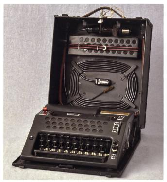
Figure 11: Machine de chiffrement NEMA développée en Suisse.
