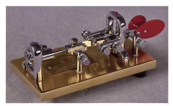
Figure 27: Manipulateur Morse, modèle semi-automatique.
