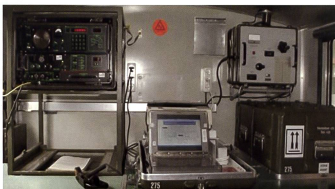
Figure 8 : Station radio SE-430 avec ensemble télématique 430 (TmS-430).
