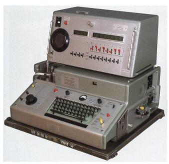
Figure 12: Téléscripteur crypté radio KFF-58 développée en Suisse.
