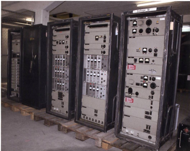
Figure 22: La station mobile UKR RB-1111, de droite à gauche avec l'émetteur-récepteur, le distributeur de canaux (démodulateur), le collecteur de canaux (modulateur), l'appareil de chiffrement à clé et le châssis terminal BF. Capacité de transmission: 11 canaux vocaux cryptés.
