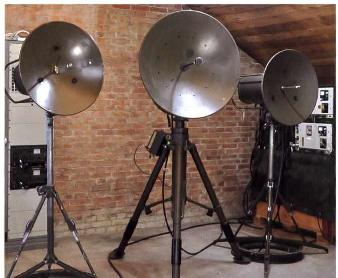
Figure 25: Les deux stations à faisceau hertzien R-902 (à gauche et à droite) et R-915 (au centre). Au fond à droite, on peut voir l'unité de commande BT de la R-902.
