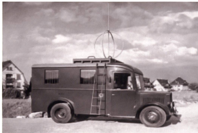
Figure 30: Radiogoniomètre à ondes longues P-708 mobile installé dans un fourgon Berna.
