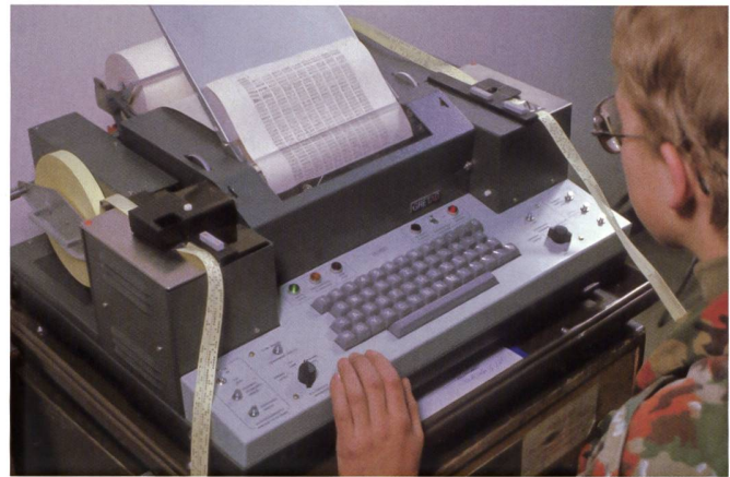
Figure 14: Appareil de chiffrage TC-850 développé dès 1973.
