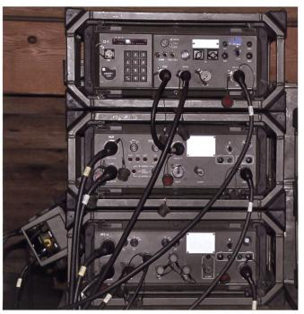
Figure 24: L'appareil multicanal MK-7 (en bas la partie NFE-A et au milieu la partie MUX), associé à l'appareil de chiffrement CZ-1 (en haut) pouvait être utilisé avec les deux stations à faisceau hertzien R-902 numériques et R-915. La capacité de transmission était de 0,5 Mbit/s, ce qui correspondait à 15 canaux vocaux. L'ensemble du faisceau était crypté. Pour exploiter la capacité du R-915 à 2 Mbit/s, il fallait 4 MK-7 pour utiliser 60 canaux vocaux.
