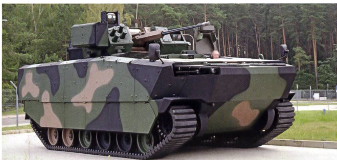
Le Borsuk d'origine koréenne est le successeur du BWP. Il pèse environ 25 tonnes mais peut recevoir un surblindage qui l'amène à 40 tonnes en ordre de combat. Son armement comporte un canon de 30 mm ainsi qu'une mitrailleuse coaxiale ainsi qu'un lance-missiles Spike LR . La tourelle est télé-opérée. L'équipage compte trois soldats et jusqu'à huit fantassins peuvent être emportés à l'arrière.
