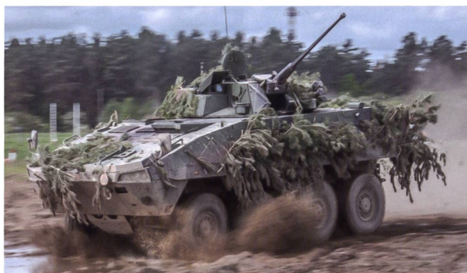
359 véhicules de combat d'infanterie à roues Rosomak produits sous licence finlandaise servent dans les unités motorisées polonaises. Il est question désormais de revaloriser ceux-ci avec une capacité de tir de missiles, afin de compléter leur tourelle armée d'un canon Bushmaster II de 30 mm.
