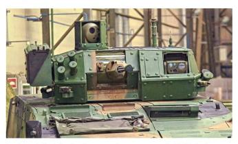
Le Borsuk d'origine koréenne est le successeur du BWP. Il pèse environ 25 tonnes mais peut recevoir un surblindage qui l'amène à 40 tonnes en ordre de combat. Son armement comporte un canon de 30 mm ainsi qu'une mitrailleuse coaxiale ainsi qu'un lance-missiles Spike LR. La tourelle est télé-opérée. L'équipage compte trois soldats et jusqu'à huit fantassins peuvent être emportés à l'arrière.
