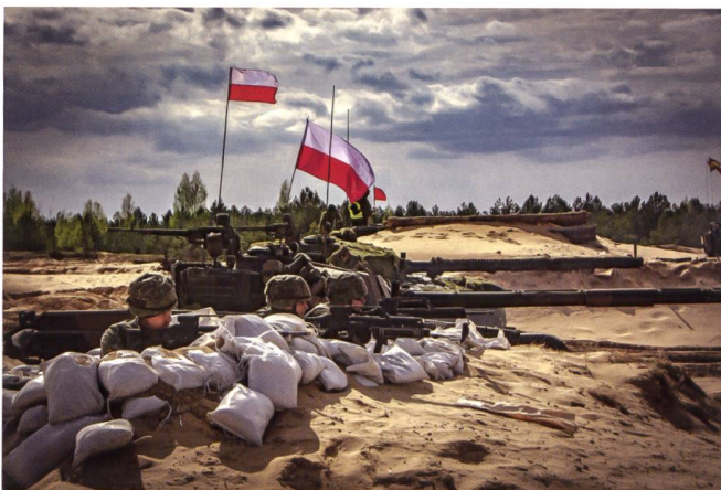
Exercice de défense sur la côte de la Baltique. Les chars de combat à l'arrière-plan sont des PT-91 - une version du T-72 produit localement avec un blindage réactif polonais et une conduite de tir occidentale.
