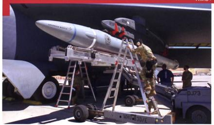
Juin 2019: Essai de tir du Air-Launched Rapid Response Weapon (ARRW) américain AGM-183, lancé par un B-52. Le missile vole à Mach 5 (6'125 km/h) puis sont 2° étage atteint Mach 20 (24'696 km/h) et peut frapper une cible à 1'600 km de distance. Photo © Lockheed Martin.
