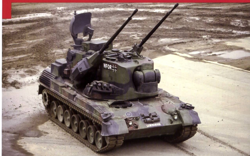
Le char de défense contre avions Gepard allemand, a également servi aux Pays-Bas et en Roumanie. L'armement consiste en deux canons de 35 mm Oerlikon (ci-dessous) fabriqués en Suisse. Photo © Bundeswehr.
