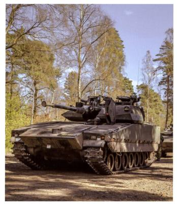
Le CV9040 surblindé est armé d'un puissant canon Bofors de 40 mm.
