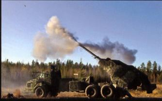
L'obusier autopropulsé *Archer* est un système d'artillerie de 155 mm/ L52 capable d'être mis en action très rapidement et de tirer des rafales de 3 à 15 coups extrêmement rapides. L'équipage complet se limite à trois hommes car toute la manutention des obus est automatisée.
