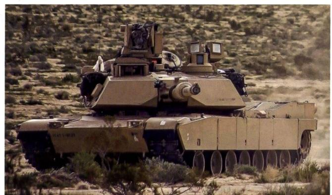
2. La version M1A2 SEPv3 est dotée d'un meilleur système de viseur infrarouge (IFLIR), ce qui augmente la capacité de combat nocturne. L'IFLIR utilise la technologie infrarouge à ondes longues et moyennes pour améliorer l'acquisition, l'identification et l'engagement des cibles par rapport au FLIR de deuxième génération existant.
