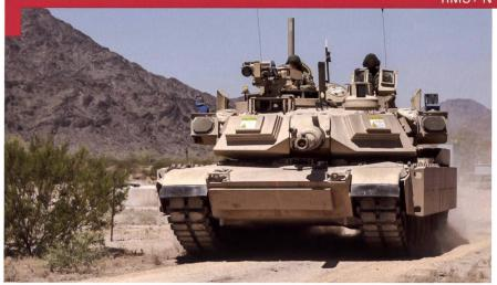
Le M1A2SEPV3 prêt au combat pèse désormais 70 tonnes et dispose de plusieurs systèmes de blindage passifs, réactifs et actifs. Les capteurs visible sur les côtés de la tourelle appartiennent au système Trophy du fabricant israélien Raphael. Toutes les photos © US Army.
