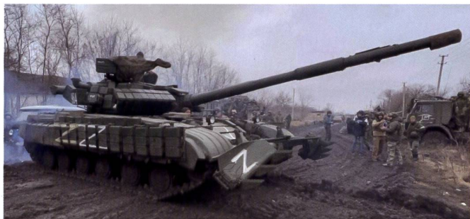
Un T-80BVM équipé d'une charue antimines manoeuvre au nord de Kharkov.
