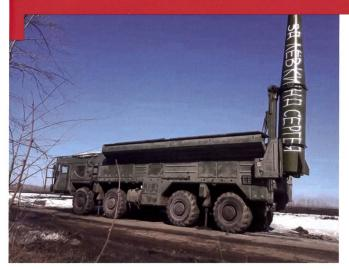
Préparation au tir d'un missile SS-26 *Iskander*. Ces engins ont une portée maximale de 50 à 500 km et la charge explosive est de 480 à 700 kg d'explosifs, des sous-munitions (cargo) ou une charge thermonucléaire (H).
