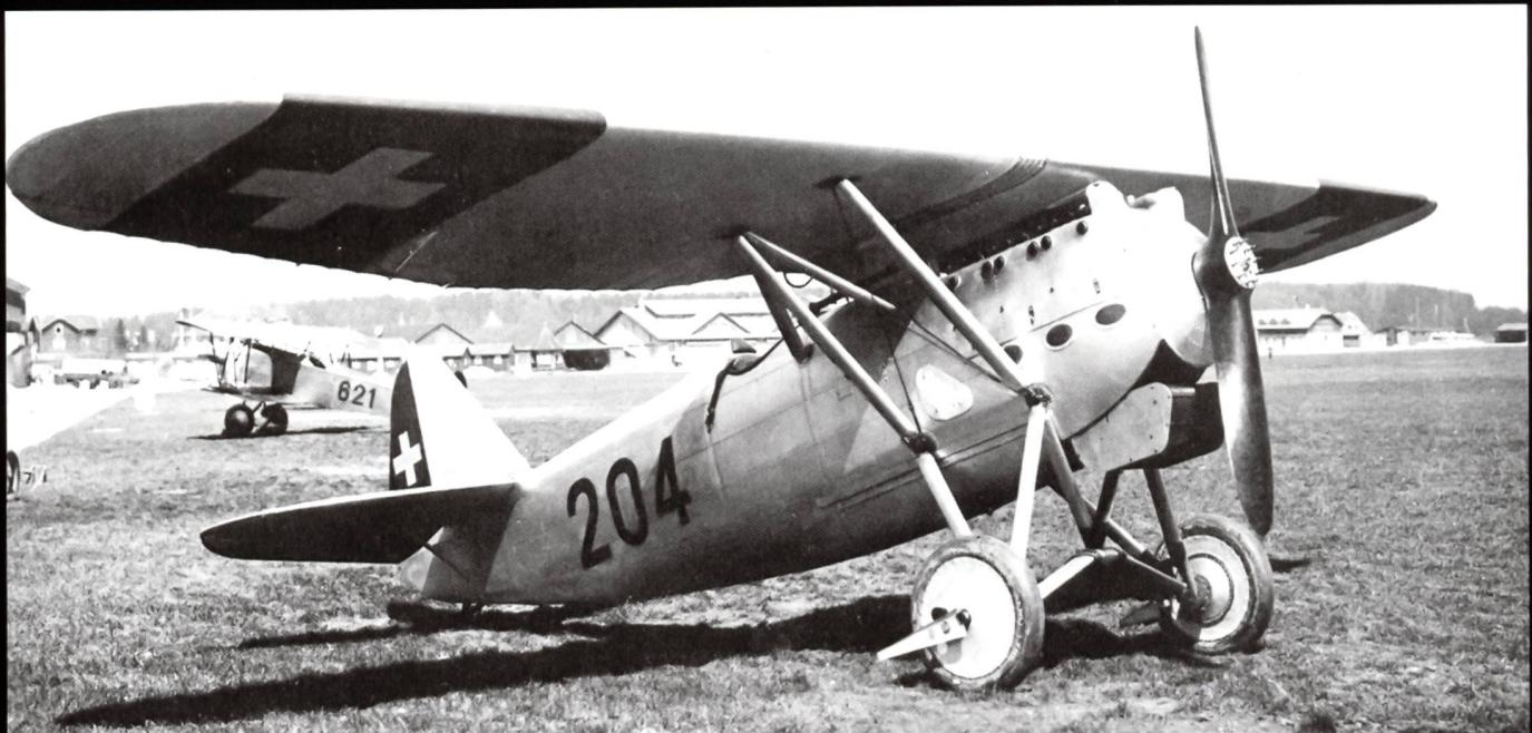
Ci-dessus : Le D27 N°2 remotorisé à 400 CV est classé dans la catégorie des appareils de travail aérien et acrobatie. Il contribua ainsi à parfaire le renom mondial du pilote et du constructeur. Moteur Hispano Suiza 500 ch., vitesse maximum 312 km/h, autonomie 600 km, poids 1382 kg.
