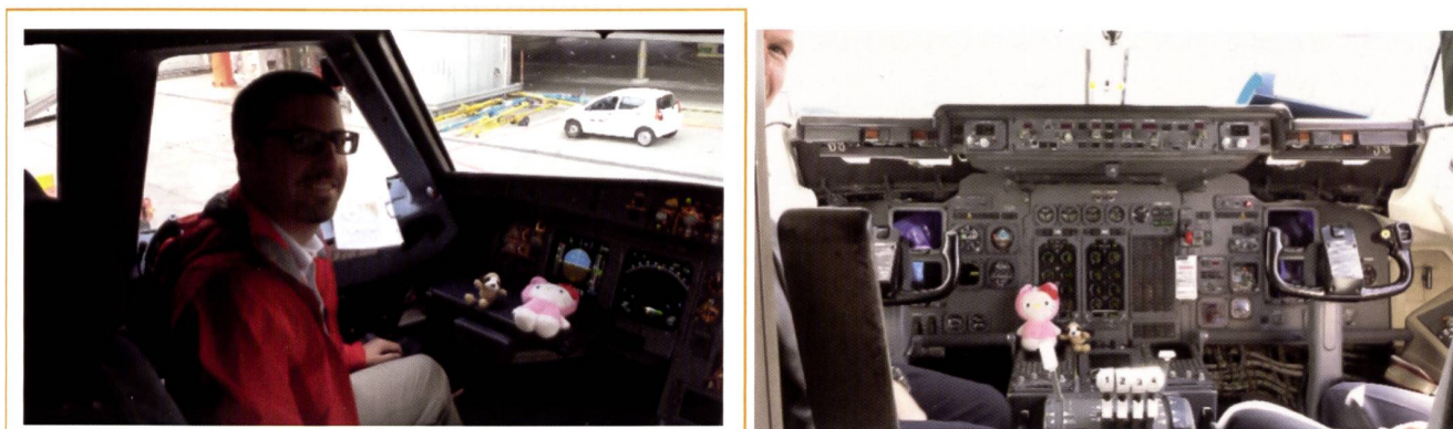
Figure 1 : Exemples de cockpits d'avions commerciaux, à gauche un Airbus A320 et à droite un British Aerospace 146. Sur l'Airbus, les commandes de vol sont placées sur le bord extérieur du cockpit, peu visibles ici et encore moins assis dans le siège du copilote, alors que sur le British Aerospace les commandes sont centrales et bien visibles en position assise. Les actions produites par un pilote ne sont pas détectables de la même manière selon la configuration du cockpit.
