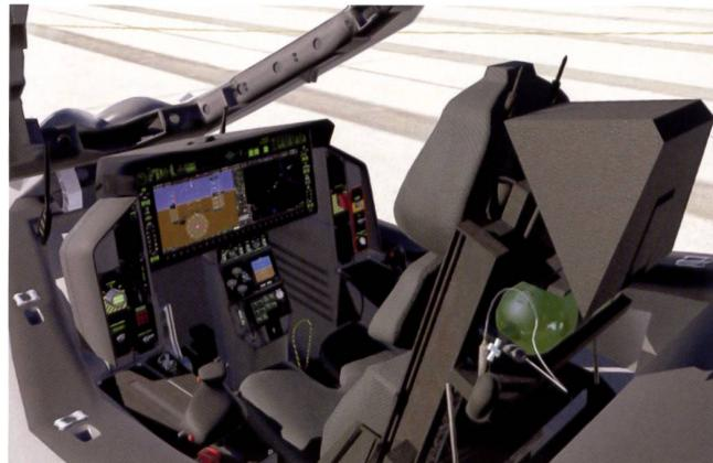
L'architecture numérique et les capteurs du F-35A en font un des appareils les plus modernes du monde. Une de ses caractéristiques est d'avoir abandonné le classique collimateur tête haute (HUD) pour un viseur de casque intégré.
