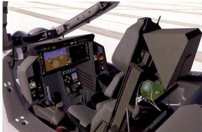
L'architecture numérique et les capteurs du F-35A en font un des appareils les plus modernes du monde. Une de ses caractéristiques est d'avoir abandonné le classique collimateur tête haute (HUD) pour un viseur de casque intégré.
