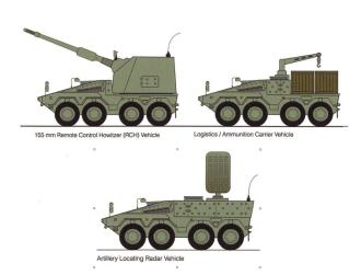
Ci-dessous et ci-dessous: L'architecture modulable du *Boxer* permet d'envisager une famille d'engins pour assumer l'ensemble des tâches au sein d'une unité d'artillerie. La pièce de 155 mm L52 et son système de rechargement est largement repris du Panzerhaubitze 2000. Source <sup>©</sup> KMW.
