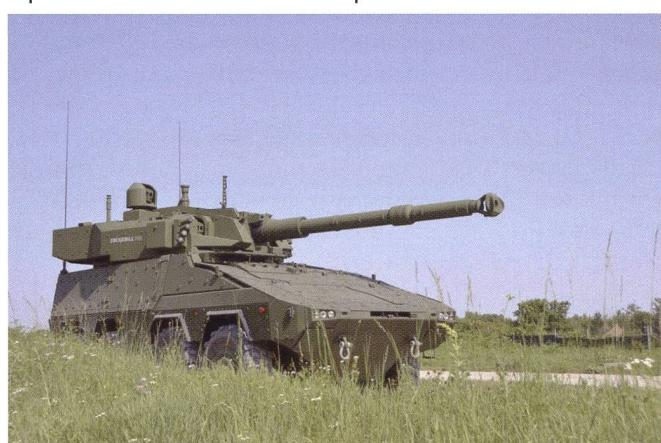
pointage et le chargement se fait de manière entièrement automatique. Des essais en 2021 ont démontré que le système pouvait être entièrement engagé à distance, sans équipage à son bord. A l'instar de son prédecesseur chenillé, la pièce emportée est une arme de 155 mm L55.
