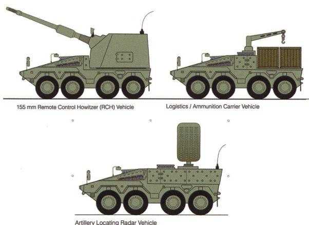
Ci-dessous et ci-dessous : L'architecture modulable du *Boxer* permet d'envisager une famille d'engins pour assumer l'ensemble des tâches au sein d'une unité d'artillerie. La pièce de 155 mm L52 et son système de recharge sont largement repris du Panzerhaubitze 2000.
