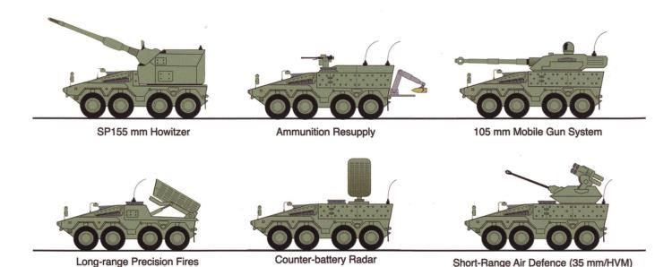
Ci-dessus et page suivante: Dès l'origine, le concept du *Boxer* a visé la modularité. La partie moteur permet l'adaptation aisée de « modules » spécialisés. L'inconvénient de ce système, malgré tout, est la hauteur massive de l'engin. Source: KMW.
