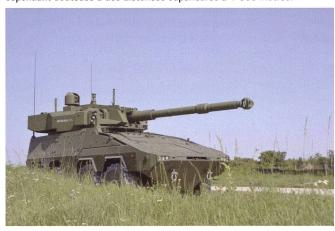
pointage et le chargement se fait de manière entièrement automatique. Des essais en 2021 ont démontré que le système pouvait être entièrement engagé à distance, sans équipage à son bord. A l'instar de son prédécesseur chenillé, la pièce emportée est une arme de 155 mm L55.
