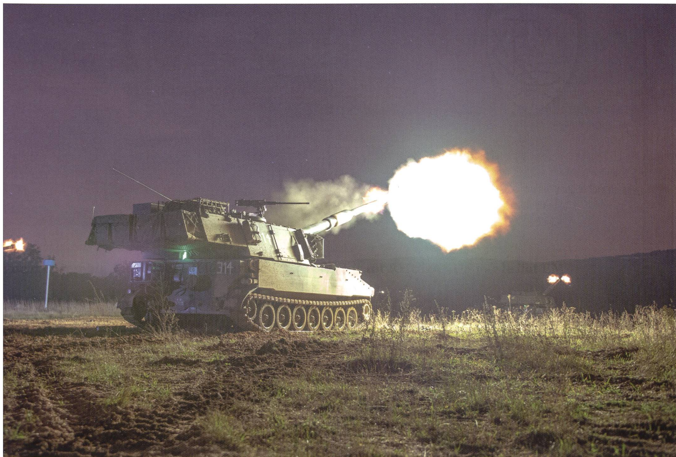
Obusier blindé 63/90 KAWEST (M-109) de la batterie 1/3 lors de l'exercice RHODANUS de la brigade mécanisée 1. Chaque batterie compte six pièces de 155 mm L47. Photo © A. V..
