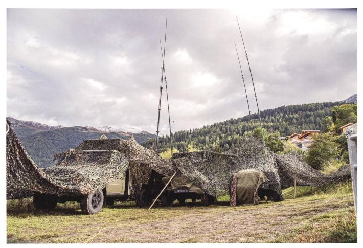
Ci-dessus : Une « ferme d'antennes » permet aux emplacements réels des échelons et postes de commandement d'échapper à l'exploration électronique. Ci-dessous : La compagnie de sûreté a pour mission de protéger les infrastructures de conduite mobiles et fixes de la brigade.
