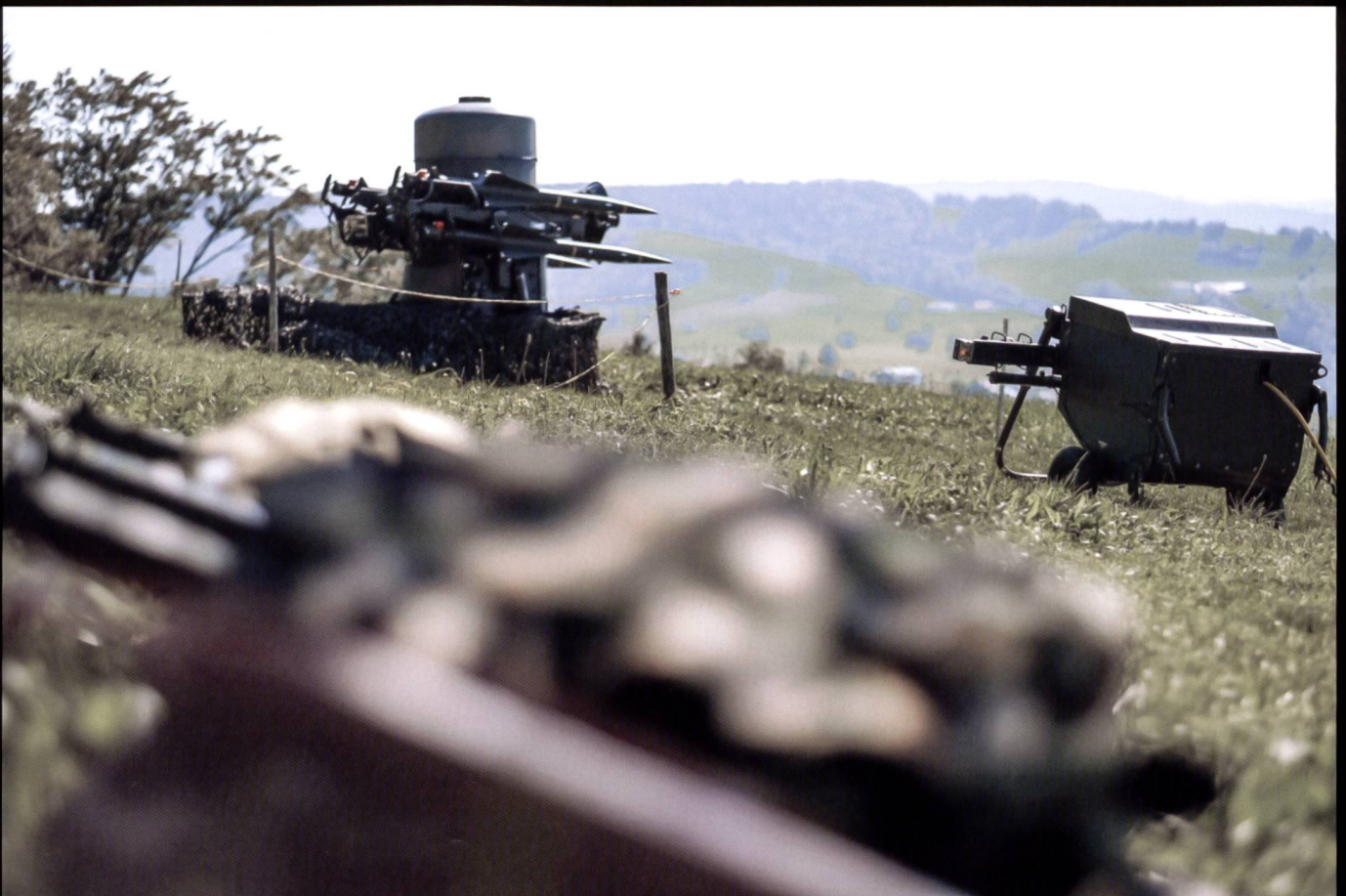
Ci-dessous : Chacune des composantes du système RAPIER dispose de son propre agrégat afin de générer le courant nécessaire à son opération, comme on le voit sur à droite de l'image.
