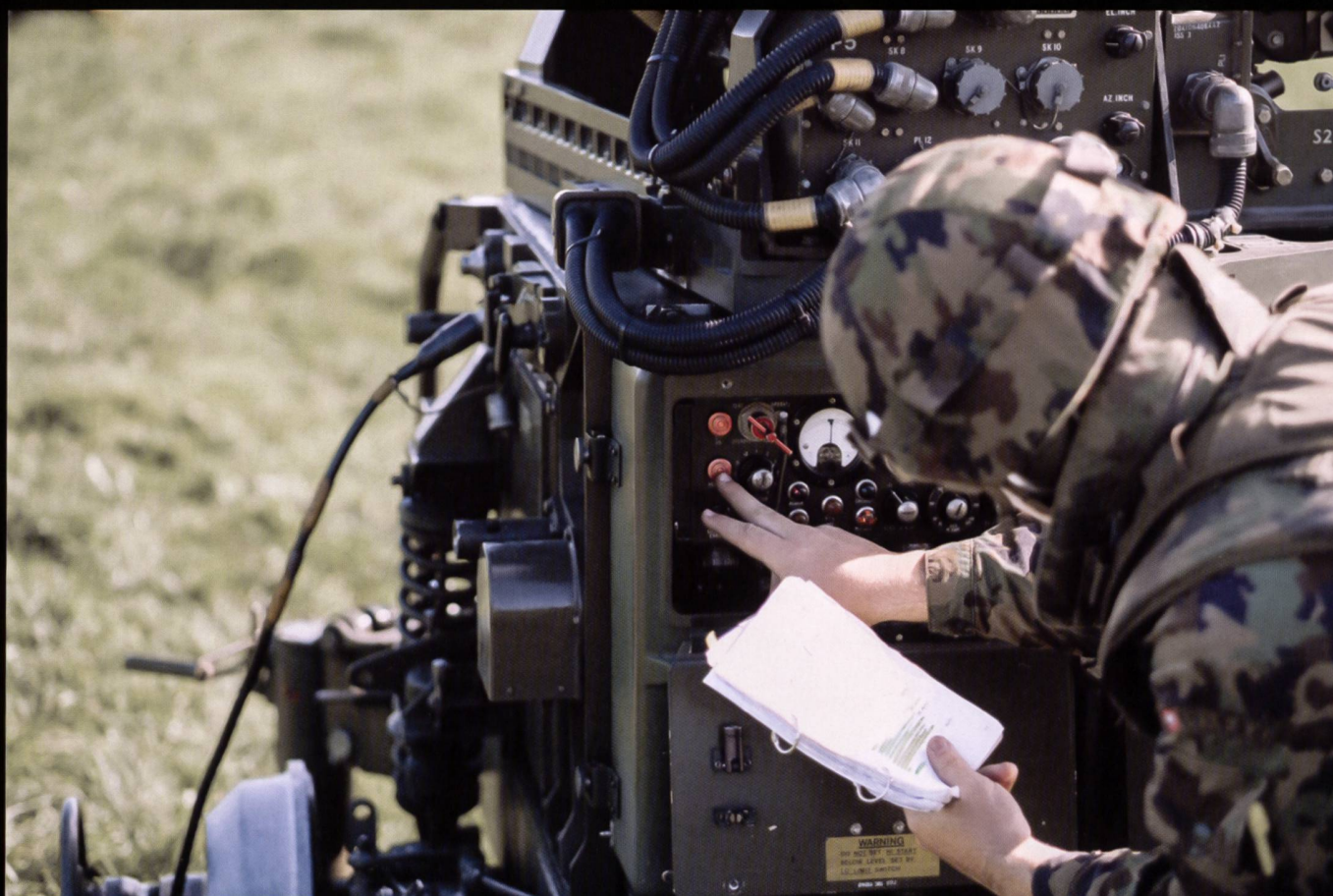
Ci-dessous : Un sergent conduit un contrôle de fonctionnement sur le radar de poursuite.
