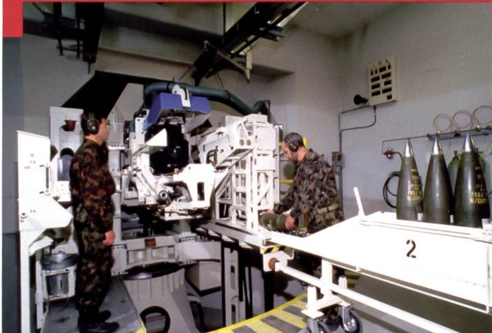
Ci-contre : Le canon *Bison* de 15,5 cm L52 disposait d'un système de chargement automatisé afin de maximiser la cadence de tir ainsi que la portée.
