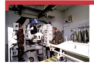
Ci-contre : Le canon *Bison* de 15,5 cm L52 disposait d'un système de chargement automatisé afin de maximiser la cadence de tir ainsi que la portée.
