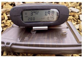
Le chronomètre électronique récemment introduit dans l'armée permet de mesurer le nombre de coups tirés, le temps total et l'intervalle entre les coups. Il convient particulièrement pour ce genre d'exercice.
