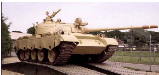
Le Type 69 se distingue de son prédécesseur par la longueur de sa carcasse, ainsi que par ses optiques de vision nocturne infrarouge.
