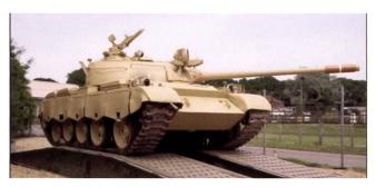
Le Type 69 se distingue de son prédécesseur par la longueur de sa carcasse, ainsi que par ses optiques de vision nocturne infrarouge.
