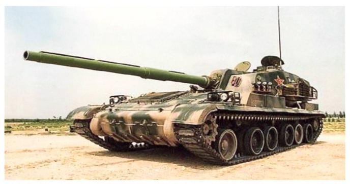
Malgré sa ligne élégante, le chasseur de chars Type 89 a rapidement été rendu redondant par les nouvelles technologies permettant aux chars de combat d'observer et de combattre en mouvement.
