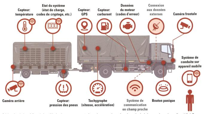
Schéma de principe: A l'avenir, les véhicules de transport seront mis en réseau avec le système de gestion logistique par de nombreux dispositifs IoT. Illusration © CME.
