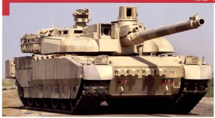
Ci-contre et ci-dessous: Les engins emirati ont été reçu plusieurs « kits » de modernisation, y compris des blindages réactifs à l'avant et des grilles à l'arrière, ainsi que divers systèmes de protection rapprochée - à l'instar de la tourelle télé-opérée installée derrière les écoutilles de l'équipage.
