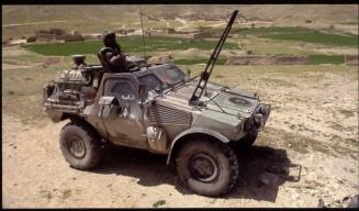
Ci-dessus, à gauche: Deux VBL engagés au Mali. En raison du manque de place, le paquetage doit être emporté sous la forme de charges externes. Ci-dessus, à droite: Deux engins du 1er régiment de hussards parachutistes en Afghanistan (ISAF). L'engin du haut est équipé d'une tourelle destinée à protéger le servant de la mitrailleuse de 12,7 mm. Tous les deux ont reçu un « coupe fil » à l'avant du capot.
