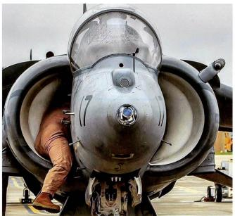
Ci-dessus: L'AV-8B (NA) ou "Night Attack" se reconnait à la protubérance nasale sur cet appareil. Au sein de l'USMC, la perche de ravitaillement en vol n'est en principe pas démontée.
