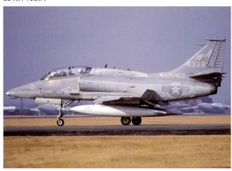
A moins de 5 tonnes à vide et grâce à ses dimensions extrêmement compactes (8,38 mètres d'envergure et 12,23 mètres de long), le A-4 peut être embarqué sur un porte-aéronef sans avoir besoin d'ailes escamotables. Il peut alors aisément être embarqué sur les porte-avions construits pendant la Guerre et dont la plupart servent désormais de navires d'escorte, de lutte anti-sous-marine ou d'assaut amphibie.
