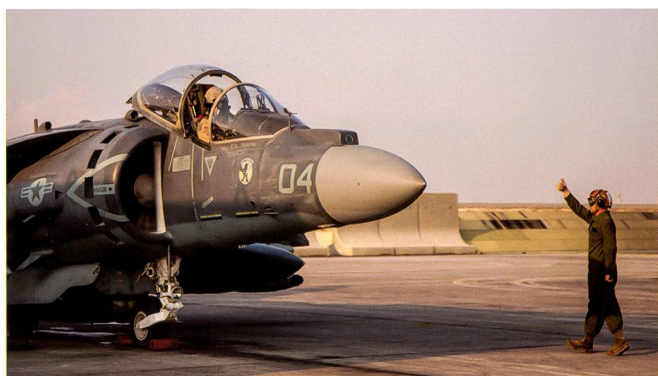
Un AV-8B+ du VMA-223 "Bulldogs" prêt à décoller. Le canon de 25 mm n'est pas monté et a été remplacé par deux lames qui permettent de créer un coussin d'air chaud sous l'appareil.
