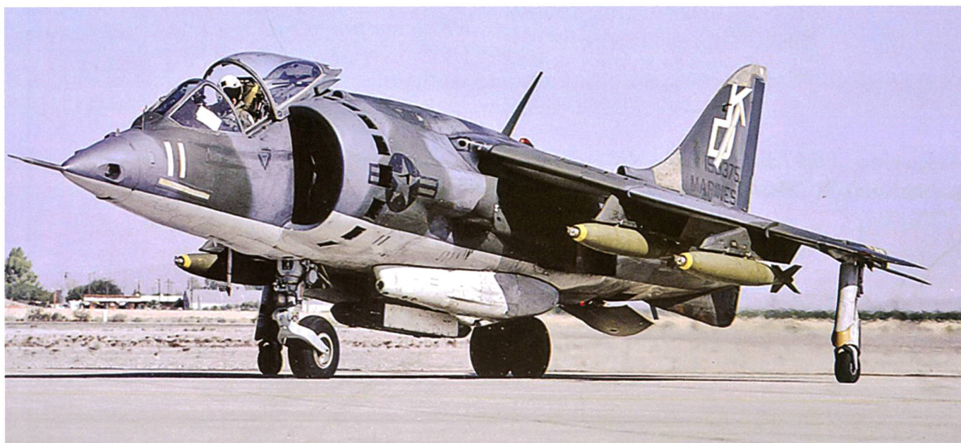
AV-8A de la formation d'entraînement VMAT-203. Il est équipé de quatre bombes Mk. 82 de 227 kg sous les ailes. La première génération de Harrier est également armée de deux canons britanniques Aden de 30 mm installés dans deux nacelles ventrales.
