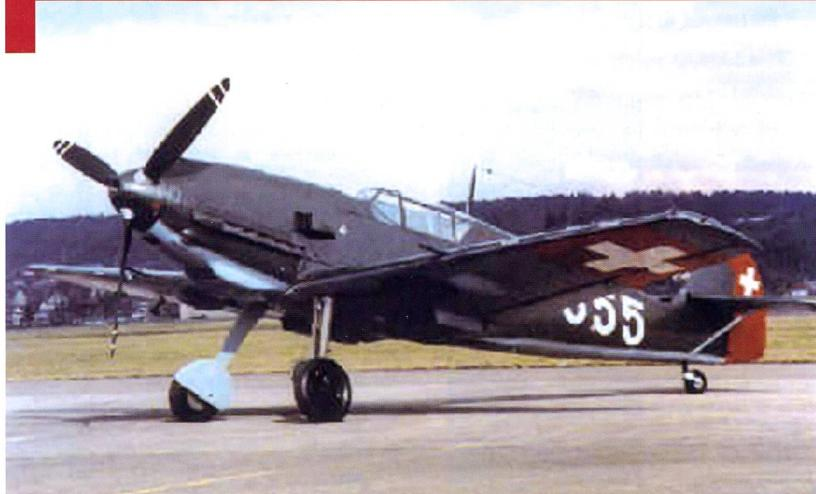
Un Messerschmitt Bf-109 E-3 « Emil » motorisé par un V-12 Daimler Benz DB-601 et disposant d'une hélice tripale à pas variable. L'appareil devait être armé de deux mitrailleuses de 7,5 mm dans le nez et de deux canons de 20 mm dans les ailes.
