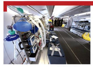
L'intérieur d'un A330 MRTT équipé du module *Morphée*.
