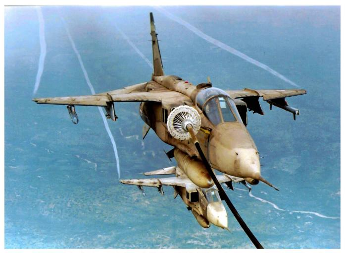
Deux Jaguar A français en livrée « désert » et en train d'être ravitaillés. Ils sont équipés de bidons et de contre-mesures électroniques *Phimat* et *Barax*. Le premier permet l'éjection de paillettes (chaff) faisant office de leurres électromagnétiques. Le second est un brouilleur actif. Tous deux ont été étalonnés pour agir en priorité contre les radars à haute fréquence des défense aériennes tactiques du Pacte de Varsovie.
