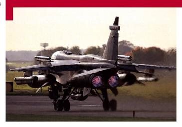
Un Jaguar britannique GR. Mk. 3, modernisé en 1996 et capable d'emporter des missiles air-air d'autoprotection en extrados (au-dessus des ailes), ainsi qu'une panoplie importante de contre-mesures électroniques et de nacelles de reconnaissance ou de désignation de cibles.
