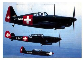
De haut en bas, le D-3801, C-3601 et Pilatus P2 · tous construits pendant la Guerre. Le P2 est un avion d'entraînement, construit à partir de certaines pièces détachées de Messerschmitt 109.
