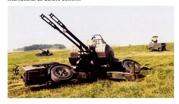
Ci-dessus: Le canon de DCA 63/90 et le système Skyguard n'a pas été délégué aux Grandes Unités des Forces terrestres. Il est destiné à protéger des objets de haute valeur et des infrastructures critiques. Ci-dessous: Le radar ALERT permet d'augmenter sensiblement l'efficacité et la durabilité des formations *Stinger*.
