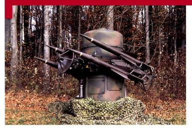
L'engin guidé à moyenne portée BL 84 Rapier est guidé par radar et peut intercepter des appareils très rapides jusqu'à 3'000 mètres d'altitude et près de 6'000 mètres de distance.
