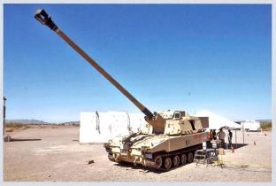
Ci-dessus: Le protoype armé d'un tube allongé, de 58 calibres. Les essais de tir ont été réalisés à Yuma, dans l'Etat d'Arizona.
