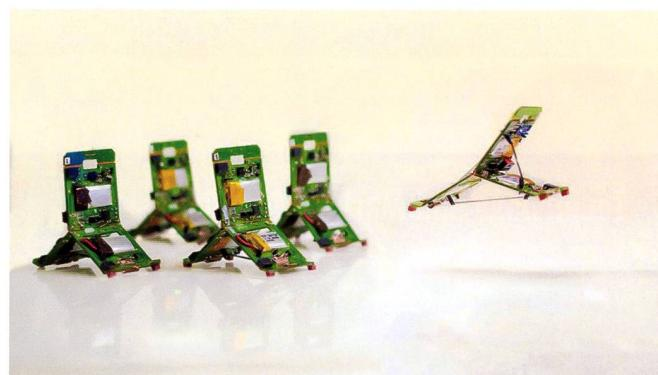
Inspirés de l'intelligence collective des fourmis, de petits robots (baptisés « Tribots ») de 10 grammes développés à l'EPFL peuvent communiquer entre eux, s'attribuer différents rôles et réaliser ensemble des tâches complexes. Dotées d'une structure simple, ces machines reconfigurables sont capables de sauter et ramper pour se déplacer sur des surfaces accidentées.
